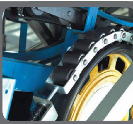
Particolari del motore e del sistema di tensione del corrimano.
